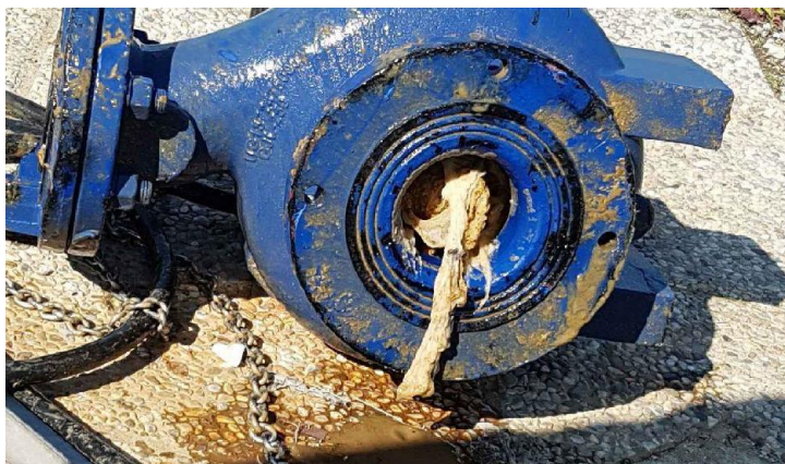
Slika 2: Zamašena črpalka zaradi krp, vlažilnih robčkov ipd.
