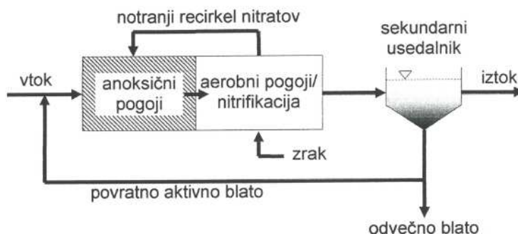
Slika 1: Shema biološkega procesa čiščenja na KČN Sežana.
